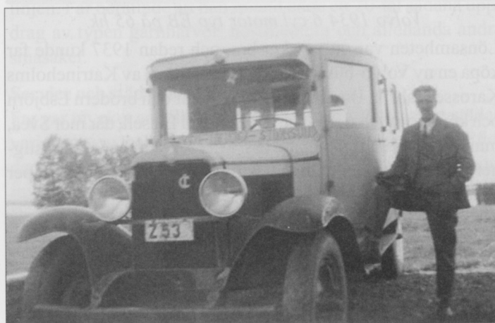
Chevrolet 1929 6-cylindrig motor 52 hästkrafter
